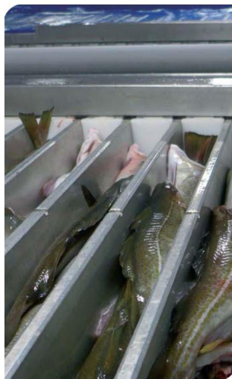
Figura 5: Bacalao congelado en congeladores de placas verticales. (foto: Guro M. Tveit, SINTEF Ocean)
